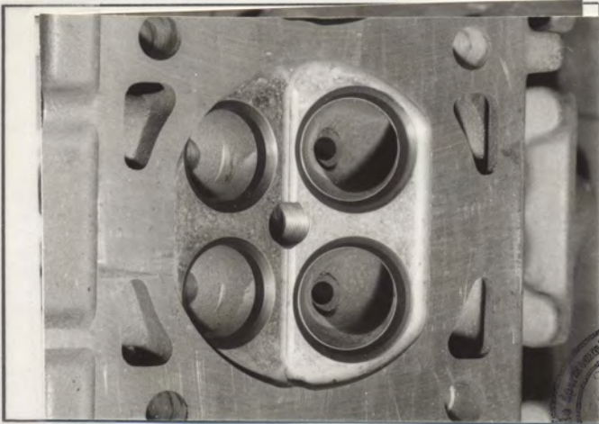
G) Verbrennungsraum Combustion chamber
